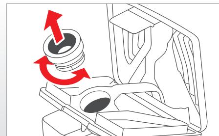
Si le filtre d'aspiration a été retiré, replacez-le dans la cuve d'eau usée.
