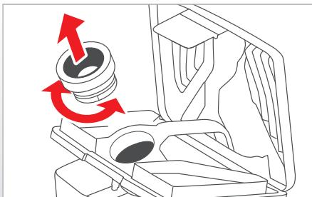
Bei starker Verschmutzung kann der sogenannte Ejektor durch Drehen der Stutzendichtung für die Reinigung entnommen werden.
